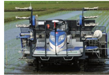
自動運転田植機 ロボットトラクタ
