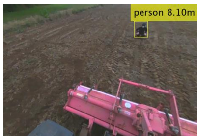
作業者 - 3DLiDAR間 水平距離検出
