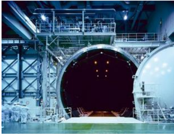
スペースチェンバ：熱真空試験
