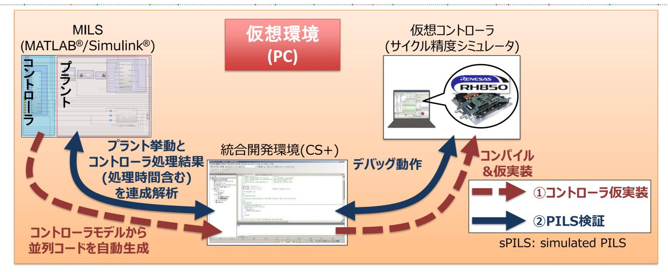
サイクル精度シミュレータを用いることで 実機コントローラが無くてもPILS検証可能
