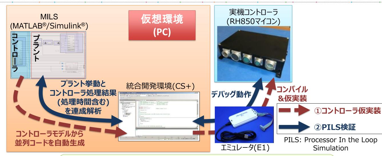
MILSモデルがあれば実プロセッサによる 正確な並列処理時間、演算結果の検証が可能 (ただし、モデル演算部のみ)
