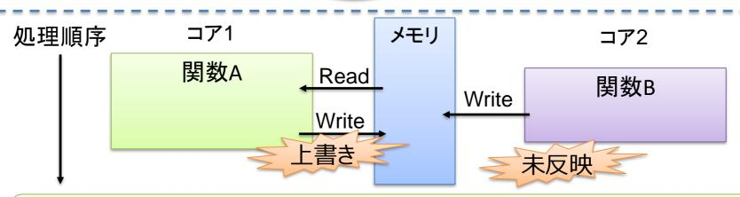
並列処理化によりメモリアクセス順序を適切に設定しないと 意図しない反映・未反映が発生
