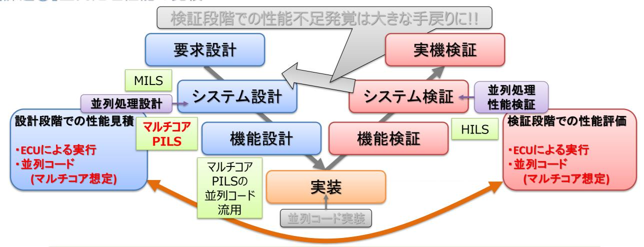
・設計段階で実プロセッサ・並列コードによる検証が可能になり性能見積の精度が向上 ・検証過程がフロントローディング化でき、HILS工程の簡略化にも貢献
