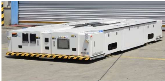
4WD4WSタイプ 30t 積AGV
