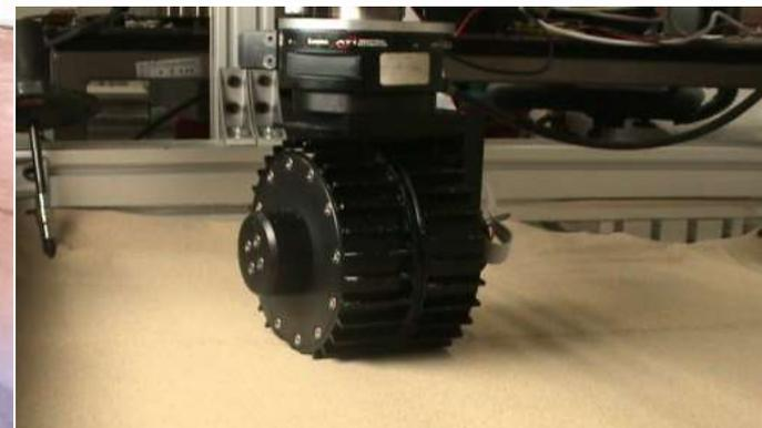
単輪試験装置により，走行力学データを取得する。
