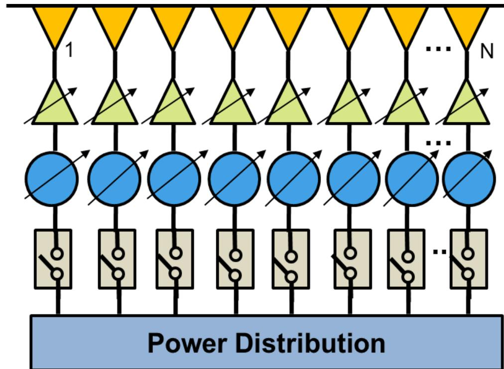
您可以使用优化工具执行阵列合成来驱动方向图属性
