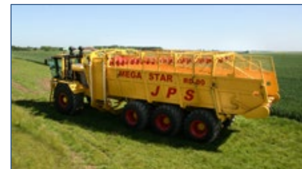
Vintec 多轴收割机 整个收割机控制系统在3个PLC上实现
