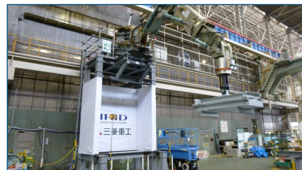
三菱重工开发用于清除核燃料碎片的机械臂 长7米、承载高达2000公斤反作用力
