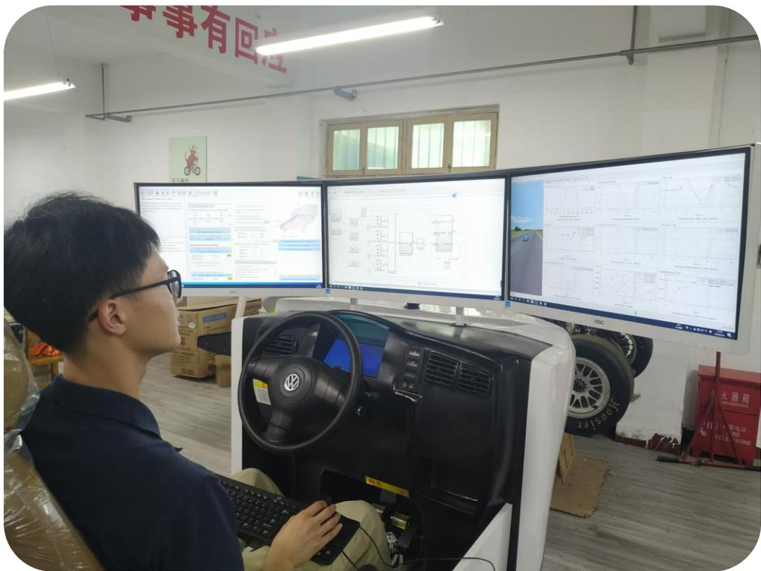
自动驾驶决策算法在驾驶模拟器上的 SIL 测试
