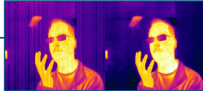
原始图像（左）和应用滤波器（通过 HDL Coder 开发而得）后的图像（右）
