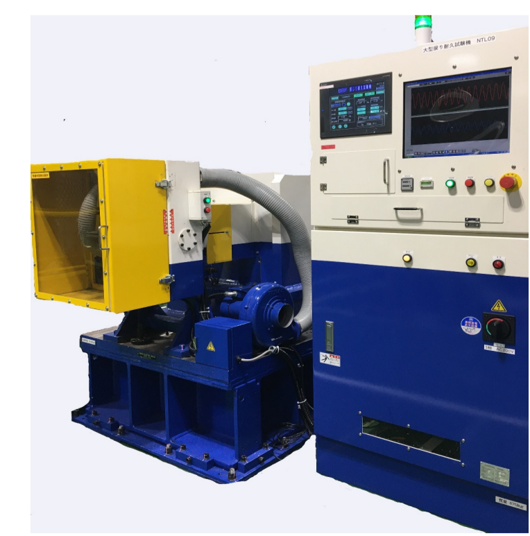
図12 電気サーボ振り試験機 実機
